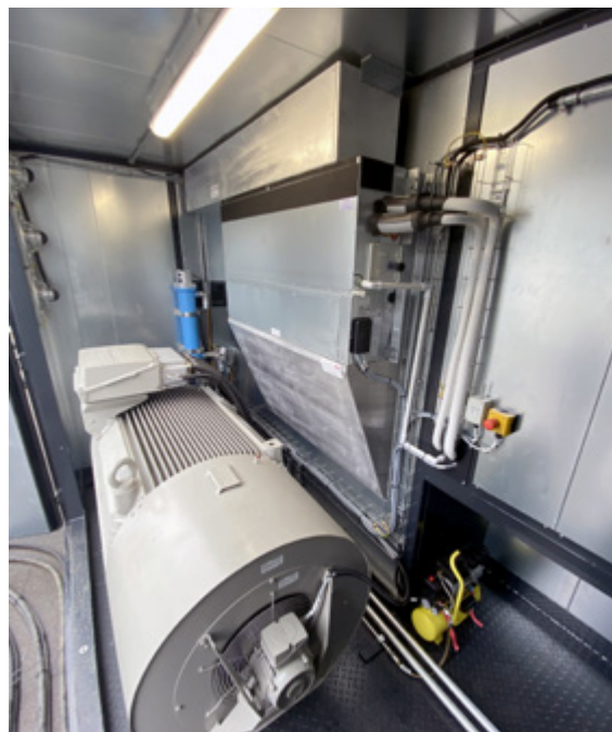
Der Elektromotor der hocheffizienten Spülpumpe HPP600-E
