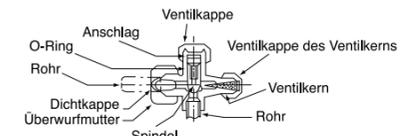
Der Kühlmittelweg ist offen und das Kühlmittel fließt von dem Außengerät zum Innengerät.
