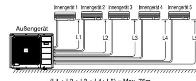
Die minimale Rohrlängelänge für jede Inneneinheit ist 3m.
