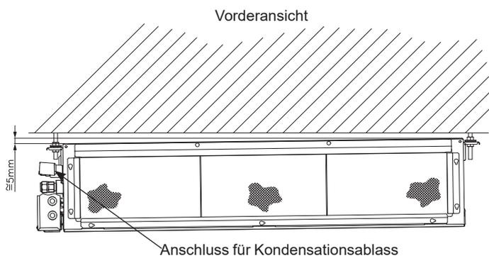
Ziehen Sie die Muttern der Montagehalterungen fest, nachdem Sie die Ausrichtung abgeschlossen haben.
