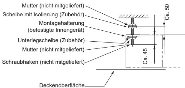
◆ **Hängen Sie das Innengerät mithilfe der folgenden Schritte auf**
