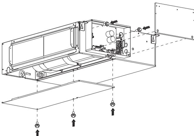
**◆ Montieren Sie den Schaltkasten an der Wand**
